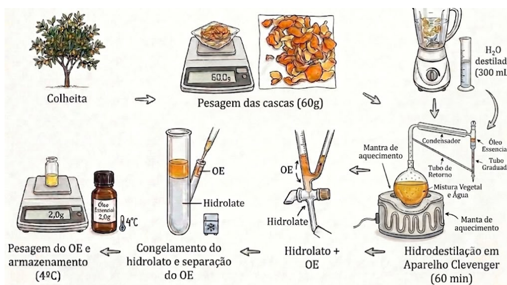
Figura 1 - Fluxograma de hidrodestilação de óleo essencial das cascas de Citrus limetta .
